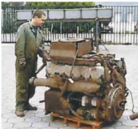
De 12 cylinder Maybach motor is uit het voertuig gehaald op het terrein van Visker.
