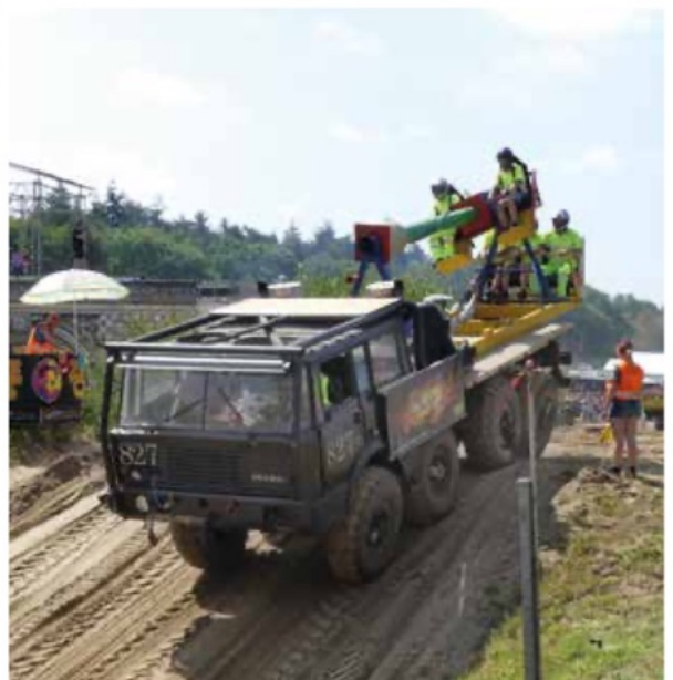
▼ Hierboven is hij al op de achtergrond te zien. De Tatra 813 'Kolos'. Als hij de springheuvel af gaat is goed te zien hoe zijn onafhankelijke vering werkt.
